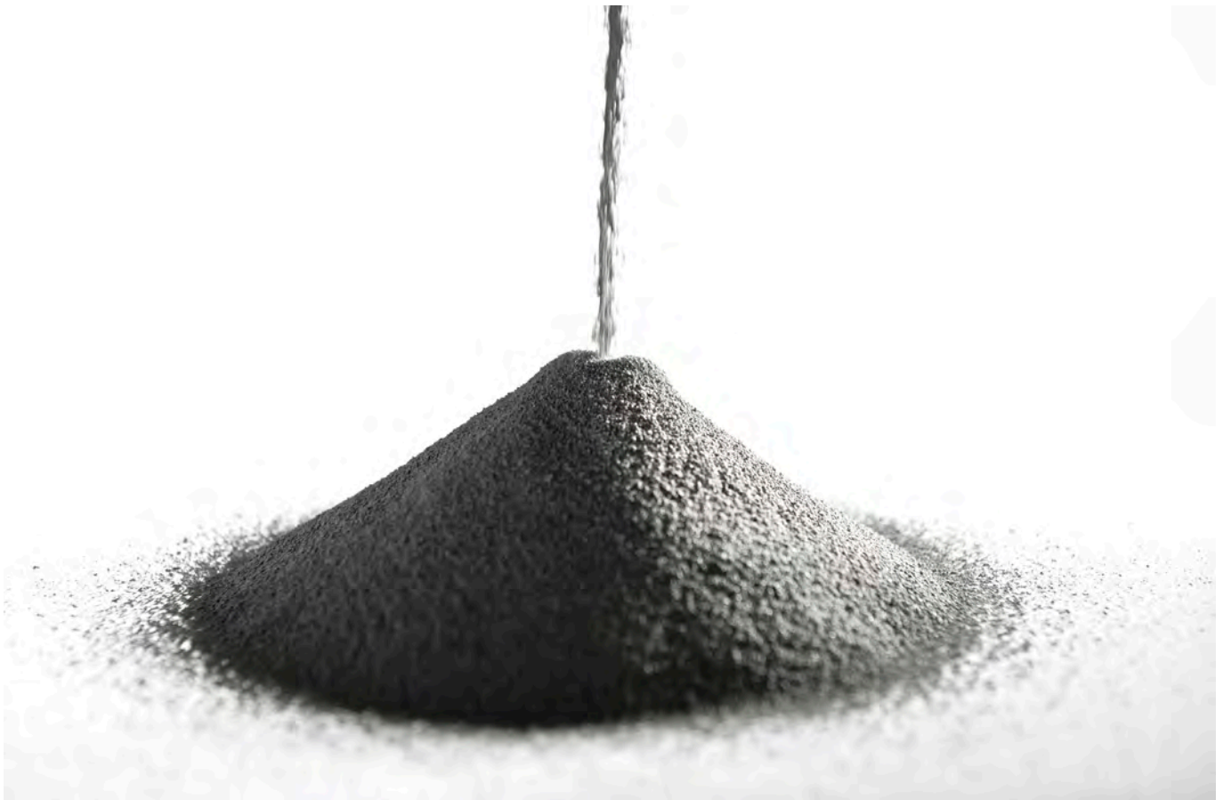
Das feinkörnige SMC-Pulver ist ein wesentlicher Bestandteil des Hochleistungs-Magnetsystems der EPICON-Tieftöner.
